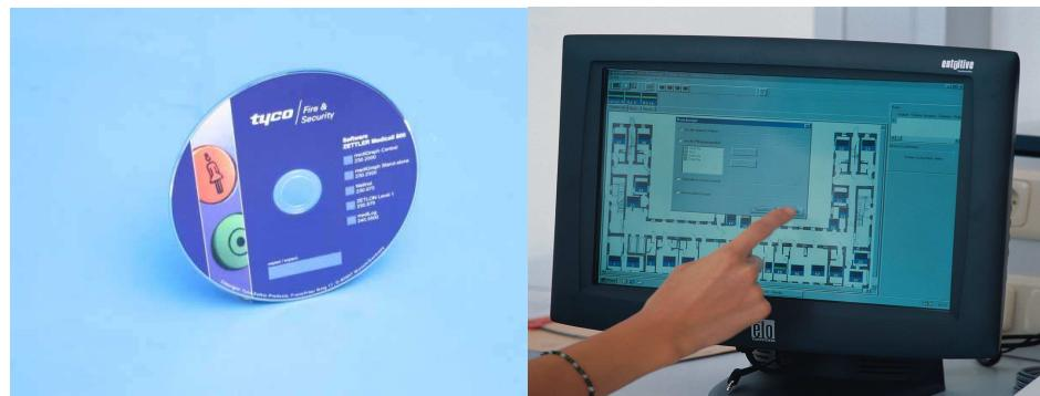
Le logiciel Medilog permet l'enregistrement et l'archivage des données transmises sur le bus de donnée. Toutes les actions de présences, d'appels, de concentration, de réponse à partir de l'interface LVTI ou de défauts sont enregistrées en fonction de la date et de l'heure.
